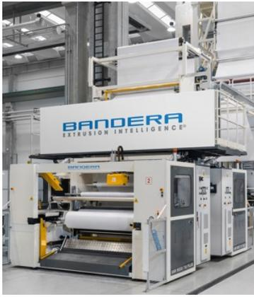
con filiera da 500 mm e sistema IBC. Particolarmente ricca la dotazione per il controllo del film: sistema automatico IBC a 8 sensori ad ultrasuoni con controllo larghezza, anello di raffreddamento ad alta efficienza a triplo flusso, sistema automatico di misurazione e controllo dello spessore, guidabolla a due gabbie e uno speciale e sistema per la misurazione dello strato barriera.
