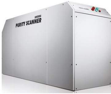
e fuori linea, della presenza di contaminanti in granuli, scaglie (flakes), film e nastri estrusi, particolarmente indicata nell'industria elettronica e medicale, dove i requisiti di purezza sono stringenti. Grazie alla combinazione di un sistema di ispezione ottico con i raggi X, lo scanner è in grado di rilevare particelle estranee (metalliche o organiche), cavità e bolle d'aria, agglomerati o colori anomali, con dimensioni fino a 50 micron, anche inclusi nei granuli.
