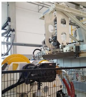
**TECNICA.** Capace di produrre fino a 1.200 kg/h di film PET, l'impianto fornito da Bandera monta un sistema di dosaggio gravimetrico a perdita di peso a 4 componenti, estrusore bivate corotante 2C 82 mm 52D, completo di sistema di degasaggio e cambiafiltro con superfiltrazione e sistema autopulente Backflush, co-estrusore monovite Tr 65mm 35D con sistema di caricamento e dosaggio della materia prima, cambiafiltro a doppia piastra. La testa piana è fornita di parzializzatori interni.
