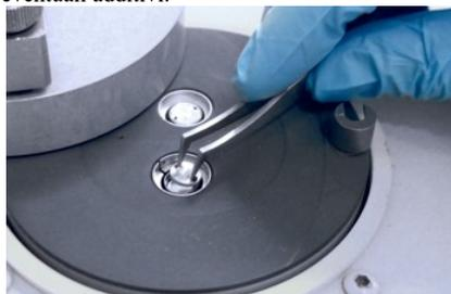
La spettrofotometria infrarossa in trasformata di Fourier (FT-IR) offre informazioni sulla struttura dei composti attraverso lo studio dello spettro di assorbimento, originato dai moti di vibrazione molecolari.
