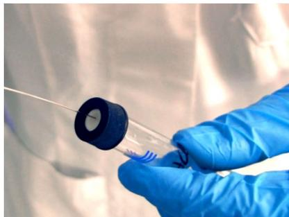
**C'È GOMMA DENTRO?** Un'altra interessante analisi è la ricerca di una componente elastomerica all'interno del materiale di cui è composto il campione. Una volta identificata la base polimerica, come nel caso precedente, si
