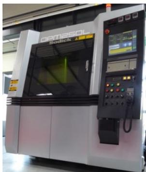
All'interno della macchina, in un'unica fase, la polvere metallica viene distribuita uniformemente sul piano di lavoro, quindi scansionata con un fascio laser Yb in fibra che la fonde e la solidifica nei punti voluti. Contestualmente, un utensile rotante esegue la finitura mediante fresatura ad alta velocità, ottenendo componenti finiti o particolari di stampi che non richiedono ulteriori lavorazioni in uscita dalla macchina.
