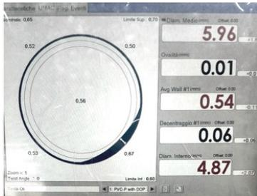
Nuovo e migliorato - segnala l'azienda - è anche sistema di misurazione del diametro esterno e spessore del tubetto su 4 punti, con visualizzazione su schermo da 15" e allarmi automatici sul mantenimento delle tolleranze dimensionali (foto a sinistra).
