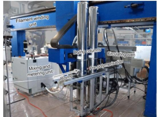
**RESISTENTI E RICICLABILI.** L'obiettivo è realizzare strutture in materiale composito con simmetria assiale, più leggere e resistenti, destinate ad applicazioni nella meccanica (sistemi di trasmissione) e nella produzione di serbatoi a pressione per gas.
