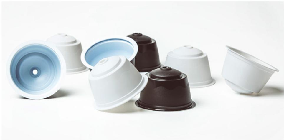
Per il confezionamento di caffè in capsula, sempre più diffuso a livello domestico, Greiner Packaging ha messo a punto una nuova soluzione, denominata “multi barrier technology” (MBT), basata sulla termoformatura di una foglia multistrato in polipropilene con all’interno uno strato barriera all’ossigeno in EVOH, che ha la funzione di preservare l’aroma e la shelf-life del prodotto per un periodo più lungo.
