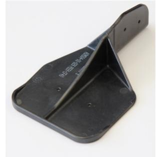
Il pezzo, stampato ad iniezione, ha sostituito la più costosa staffa lavorata a macchina da un blocco di alluminio, utilizzata in precedenza, ottenendo un risparmio di peso e di costi intorno al 40%.
