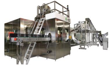
La linea integra una macchina rotativa per stiro soffiaggio della serie SBF (stretch blow forming) con il nuovo sistema compatto di riempimento AWS, capace di garantire un processo totalmente "ultra-clean". Le due macchine funzionano in sincro elettronico, senza necessità di sincronizzazione manuale, gestite dalla stessa interfaccia operatore.
