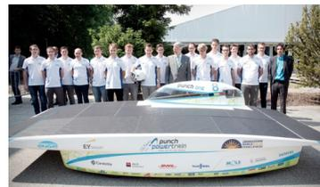
La scocca del veicolo è realizzata in un materiale composito ottenuto in parte da risorse rinnovabili (18%): i prepregs in fibra di carbonio sono infatti impregnati con una matrice polimerica a base epossidica biobased al 45%, ottenuta da resina fenolica NX-4001 di Cardolite (95% biobased, ricavata da anacardi) ed epiclorigidrina (ECH) Epicerol di Solvay, interamente da risorse rinnovabili.
