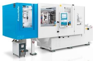
In Fiera sarà esposta una pressa CX160 equipaggiata con sistema di controllo della temperatura a induzione (Dynamic Mold Heating – DMH), fornito da Roctool, per la produzione di pezzi con aspetto superficiale di tipo olografico, ottenuto imprimendo con lo stampo diverse finiture, opaca, lucida e microforata.
