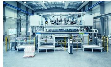
L'impianto, esposto i primi giorni di luglio nel quartier generale di Lenzing, in Austria, dispone di sei estrusori, testa piana da 7 metri, calandra di raffreddamento opportunamente dimensionata e avvolgitore capace di realizzare bobine jumbo da 60 kg.
