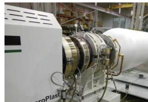
L'impianto è in grado di produrre foglie in bioplastica espansa (densità di 0,07 g/cc) con spessori compresi tra 1,2 e 5 mm, larghezza fino a 1.270 mm.
