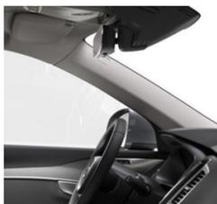
L'applicazione della tecnologia 3iTech all'iniezione consente una perfetta replica della microstruttura della superficie stampo, che migliora le proprietà ottiche del pezzo interno che compone l'involucro di IntelliSafe, evitando che il sole basso sull'orizzonte possa penetrare nel dispositivo ed accecare il radar.
