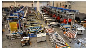
L'impianto, il secondo fornito al produttore cinese di elettrodomestici, comprende sedici unità di iniezione e polimerizzazione, allineate su due file, capaci di produrre in un minuto quattro armadi frigoriferi isolati con schiuma poliuretana.
