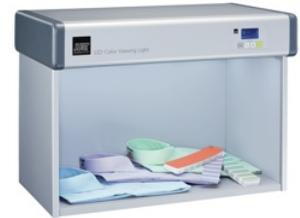
Le norme in vigore per la valutazione visiva del colore, prevedono che i campioni colore e le prove siano effettuate in presenza di una luce normata (D65, D50). L'uso di una cabina luce nel controllo di qualità è quindi raccomandato per assicurare una corrispondenza visiva rispetto ai dati e le valutazioni di uno strumento di misurazione del colore.
