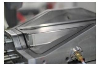
pezzo sotto pressione permette di ottenere prodotti estetici sopprimendo la fase di conformatura: "Questo considerevole risparmio di tempo apre la porta alla produzione in serie. I costruttori automobilistici sono interessati a questa tecnologia per esempio per la produzione di pezzi destinati ai veicoli elettrici".
